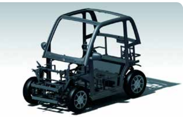
Dubbele kreukelzone met rolkooi
